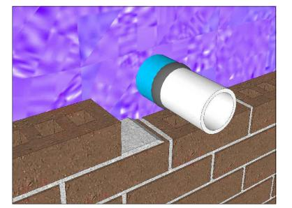
STEP 4 SPRAY WALLTITE<sup>®</sup> BEFORE LAYING BRICKS.
